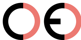
Falsche CE-Kennzeichnung (zu großer Zwischenraum)
