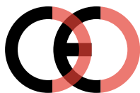
Falsche CE-Kennzeichnung (zu dicht)
